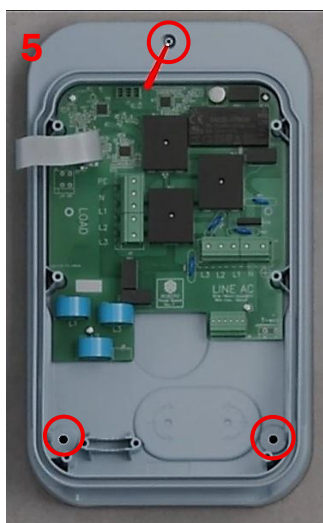
Slika 12: Označavanje rupa na zidu
