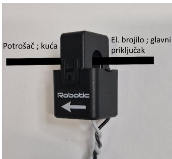
Slika 28: Strujni transformator (CT)
