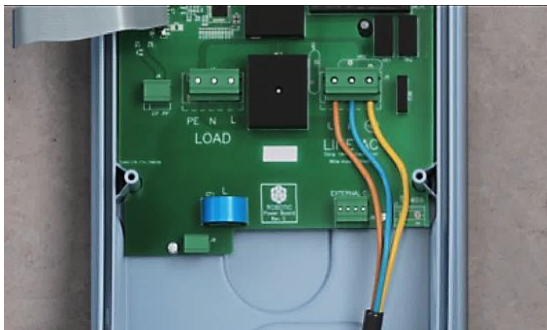
Slika 25: Unutrašnjost jednofaznog punjača
