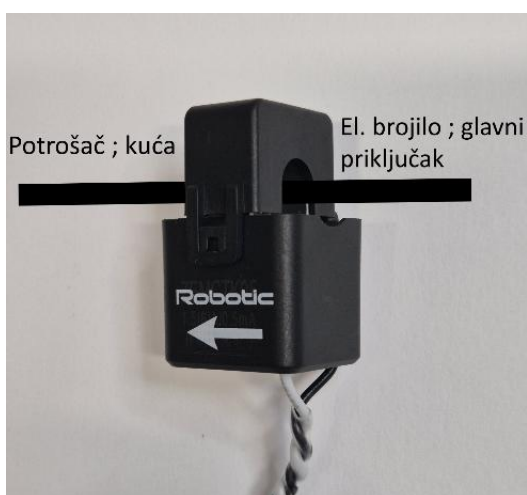
Slika 36: Strujni transformator (CT)
