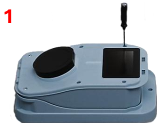
Slika 8: Skidanje prednjeg kućišta
