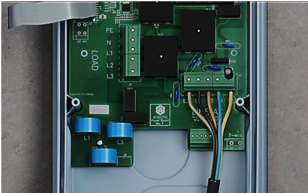
Slika 32: Unutrašnjost trofaznog punjača
